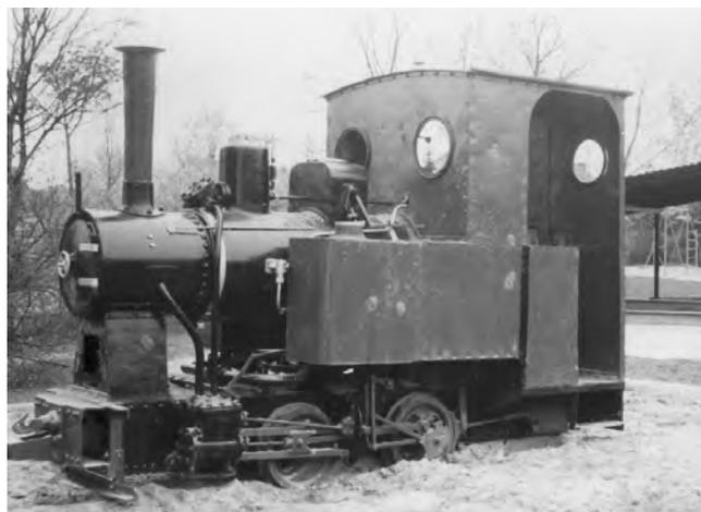
Abb. 1a Feldbahnlok der Firma Riebel aus dem Kieswerk Kaufering, aufgenommen in einem Kauferinger Kindergarten, wo sie bis 1995 als Klettergerät diente (Sammlung M. Hehl, Buchloe).
